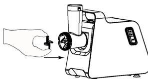
Introduzca el gusano (8) con el extremo largo en el cabezal (7). Gire ligeramente el gusano (8) hasta que quede encajado en la carcasa del motor (véase imagen 3). Coloque la cuchilla (9) en el eje del gusano como se muestra en la imagen, con las cuchillas mirando hacia fuera (véase imagen 4). Si la cuchilla no está bien colocada, no se podrá picar la carne.
