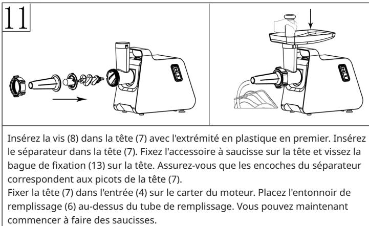
Mettez les ingrédients dans l'entonnoir de remplissage (6). Poussez délicatement la viande avec le poussoir (5) dans le tube de remplissage.
