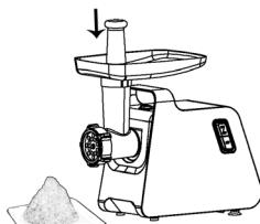
Fixez l'entonnoir de remplissage (6) en haut du tube de remplissage. Placez l'appareil sur une surface stable. La sortie d'air sur le fond et sur le côté du carter du moteur doit rester libre et jamais bloquée.
