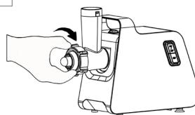
Avvitare saldamente l'anello di fissaggio (13) alla testa (7). Fissare la testa (7) nell'apertura (4) dell'alloggiamento del motore.
