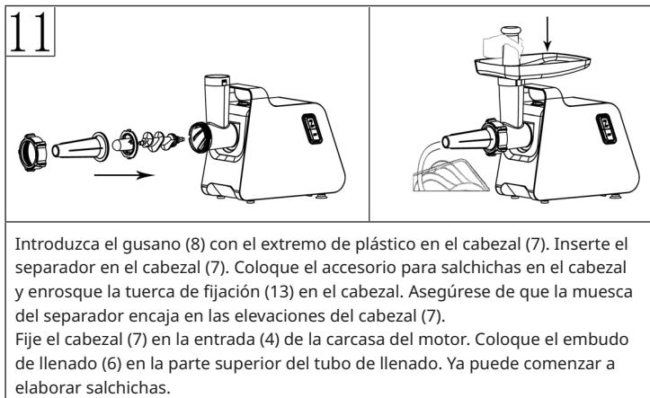
Coloque los ingredientes en el embudo de llenado (6). Introduzca con cuidado la carne en el tubo de llenado con el empujador (5).
