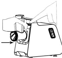
Appuyez sur la touche de verrouillage, maintenez la tête (7) et insérez-la dans l'entrée (4) du carter du moteur. Au moment d'insérer la tête (7), vérifiez qu'elle est légèrement inclinée (voir le sens de la flèche sur la figure 1). Après avoir inséré la tête (7), tournez-la dans le sens inverse des aiguilles d'une montre jusqu'à ce qu'elle tienne fermement en place (voir Figure 2).
