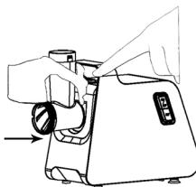
Pulse el botón de seguridad, sujeté el cabezal (7) e introduzcalo en la entrada (4) de la carcasa del motor. Al insertarlo, asegúrese de que el cabezal (7) esté ligeramente inclinado (véase la dirección de la flecha en la imagen 1). Cuando haya introducido el cabezal (7), gírelo en el sentido contrario a las agujas del reloj hasta que quede bien encajado (véase imagen 2).
