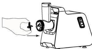
Insérez la vis sans fin (8), extrémité longue en premier, dans la tête (7). Tournez légèrement la vis sans fin (8) jusqu'à ce qu'elle soit dans le carter du moteur (voir Figure 3). Placez le couteau (9) sur l'arbre de la vis sans fin comme illustré, le couteau pointant vers l'avant (voir Figure 4). Si le couteau n'est pas installé correctement, la viande ne sera pas hachée.
