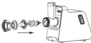
Inserire l'elica (8) nella testa (7), con l'estremità di plastica davanti. Assemblare l'attacco per kibbeh e posizionarlo poi sull'albero dell'elica.
