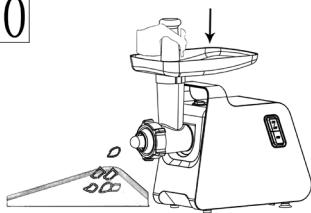
Befestigen Sie den Einfülltrichter (6) oben am Einfüllrohr. Sie können nun mit der Kibbehherstellung beginnen. Schieben Sie die vorbereitete Kibbeh-Mischung mit dem Stopfer (5) in den Fleischwolf. Sie können die Hackfleischrollen in die gewünschte Länge schneiden.
