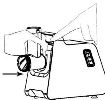
Premere il tasto di bloccaggio, tenere saldamente la testa (7) e inserirla nell'apertura (4) dell'alloggiamento del motore. Durante l'inserimento, assicurarsi che la testa (7) sia leggermente inclinata (v. direzione della freccia in immagine 1). Una volta inserita la testa (7), ruotarla in senso antiorario, fino al bloccaggio (v. immagine 2).
