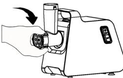
Coloque el disco perforado deseado (fino, medio o grueso) en la cuchilla (9), ajustando las muescas a la ranura (véase imagen 5).
