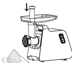
Coloque el embudo de llenado (6) en la parte superior del tubo de llenado. Coloque el aparato en una superficie estable. La salida de aire en la parte inferior y en el lateral de la carcasa del motor debe permanecer despejada y no bloquearse.
