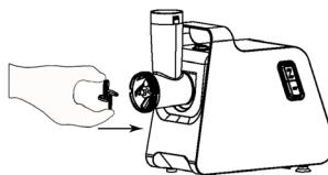
Inserire l'elica (8) nella testa, con l'estremità lunga davanti. Girare leggermente l'elica (8), fino a quando si trova nell'alloggiamento del motore. Posizionare la lama (9) sull'albero dell'elica come mostrato in immagine. La lama deve essere rivolta in avanti (v. immagine 4). Se la lama non è montata correttamente, la carne non viene tritata.
