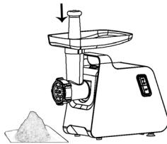
Befestigen Sie den Einfülltrichter (6) oben am Einfüllrohr.
