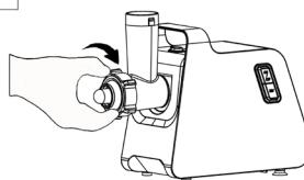
Setzen Sie die Schnecke (8) mit dem Kunststoffende voran in den Kopf (7) ein. Setzen Sie den Kibbeaufsatz zusammen und diesen dann auf den Schneckenschaft.
