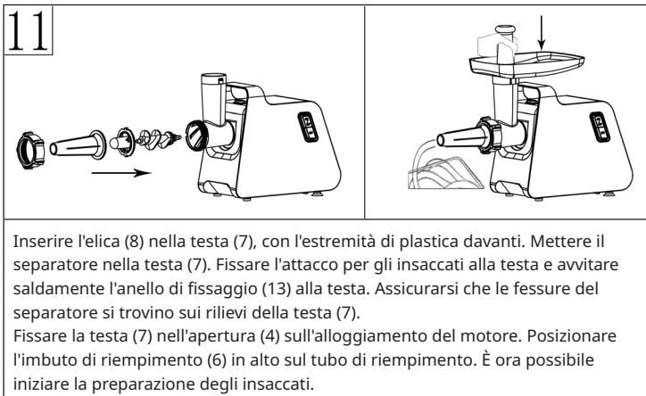
Inserire l'elica (8) nella testa (7), con l'estremità di plastica davanti. Mettere il separatore nella testa (7). Fissare l'attacco per gli insaccati alla testa e avvitare saldamente l'anello di fissaggio (13) alla testa. Assicurarsi che le fessure del separatore si trovino sui rilievi della testa (7).
