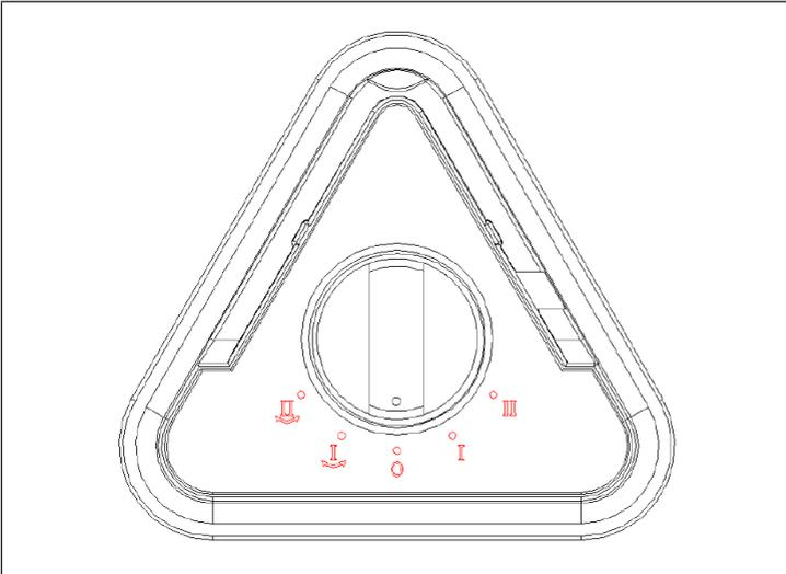
Benutzen Sie den Regler an der Oberseite des Geräts, um Heizstufe und Schwingfunktion einzustellen.
