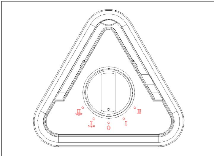
Utilizzare la manopola di controllo sulla parte superiore del dispositivo per impostare il livello di riscaldamento e la funzione di oscillazione.
