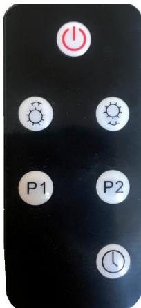
Il radiatore può essere utilizzato con i tasti del telecomando e lo schermo LED. Il dispositivo può essere utilizzato anche con i tasti sul lato anteriore.
