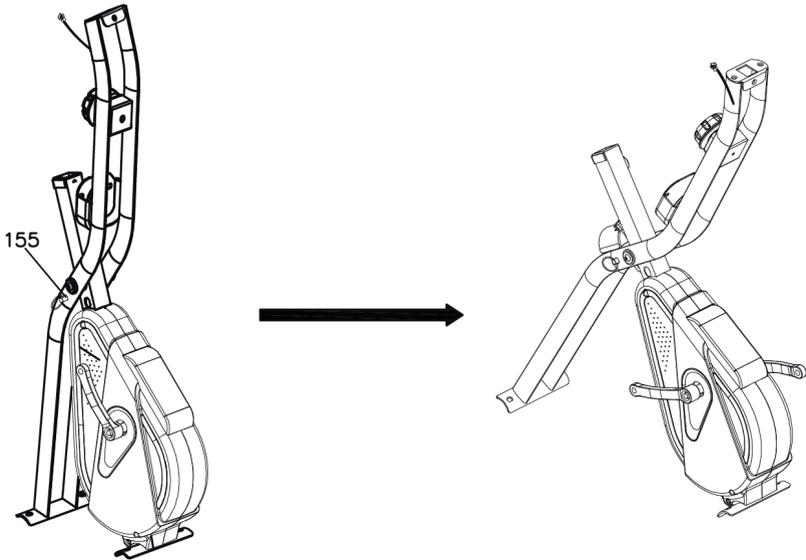
Ziehen Sie den Stift (155) heraus und entfalten Sie den Hauptrahmen. Führen Sie dann den Stift (155) in das Loch des Hauptrahmens ein.
