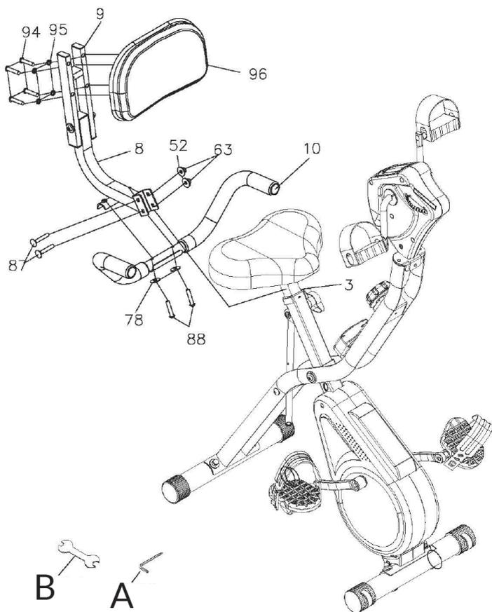
Fissare l'imbottitura dello schienale (96) all'apposito tubo di supporto (9) con 4 viti (94) e 4 rondelle elastiche (95).
