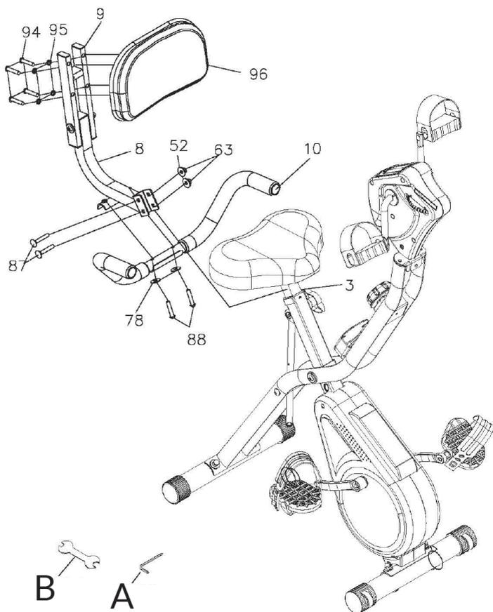
Befestigen Sie das Rückenpolster (96) mit 4 Schrauben (94) und 4 Federscheiben (95) am Rückenpolster-Stützrohr (9). Verwenden Sie dazu Werkzeug (A).
