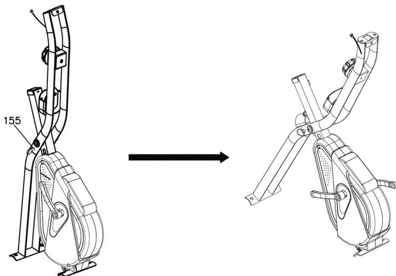
Estrarre il perno (155) e aprire il telaio principale. Quindi inserire il perno (155) sul foro del telaio principale.
