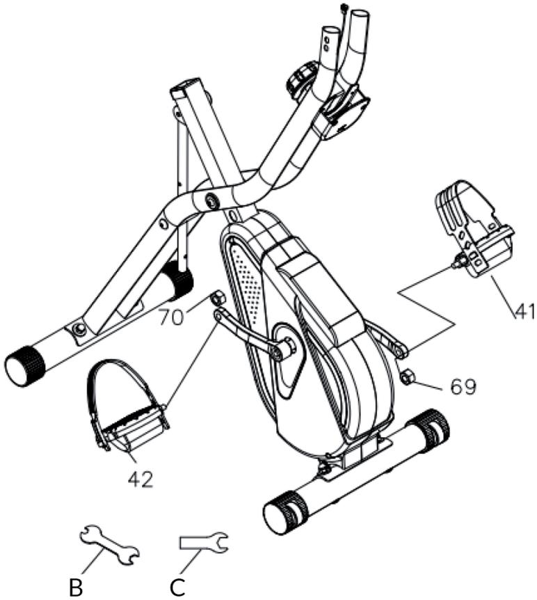
Conecte el pedal izquierdo (41) al brazo izquierdo de la manivela y apriételo con la herramienta (B) mientras aprieta la tuerca (69) con la herramienta (C).
