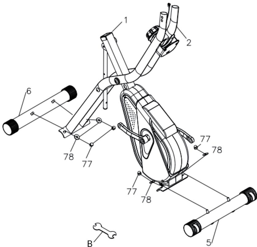
Befestigen Sie den vorderen Stabilisator (5) mit 2 Unterlegscheiben (78) und 2 Muttern (77) am Hauptrahmen (1). Verwenden Sie dazu das Werkzeug (B).
