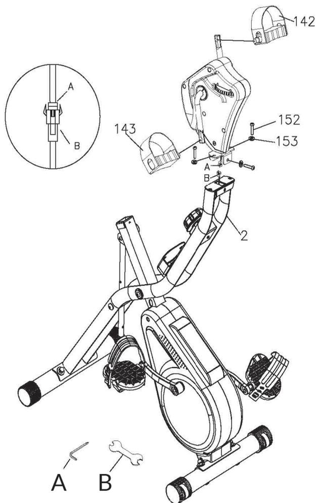
Collegare il connettore del sensore A con il connettore del sensore B.
