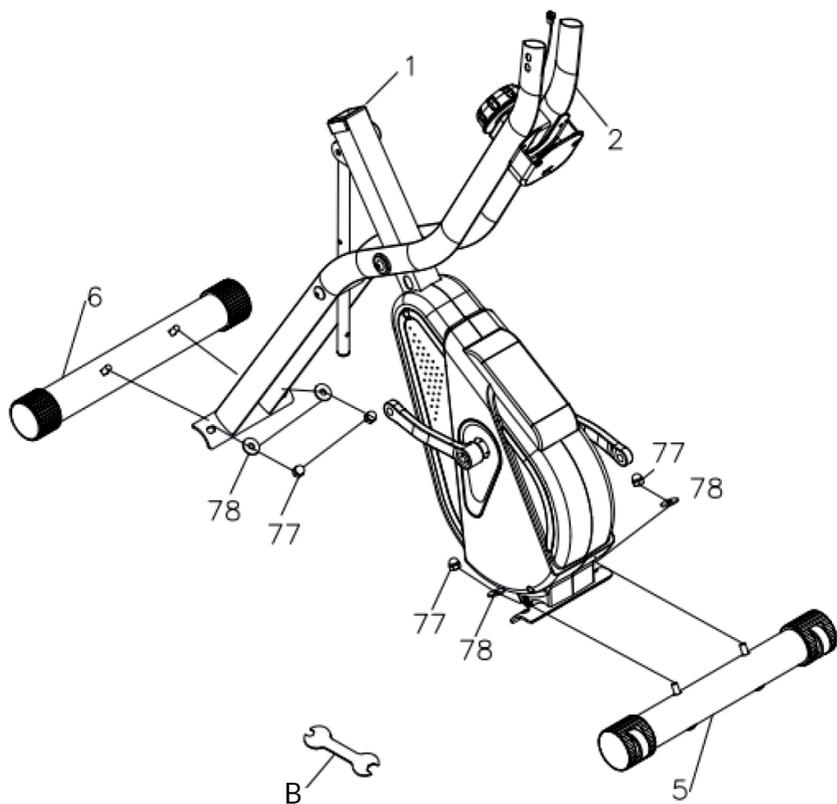
Fissare lo stabilizzatore anteriore (5) al telaio principale (1) con 2 rondelle (78) e 2 dadi (77). Utilizzare l'attrezzo (B).
