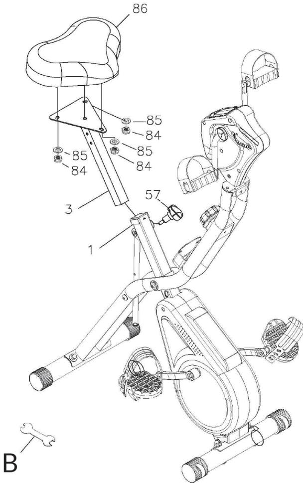
Fixez le siège (86) à la tige de selle (3e étage) avec 3 rondelles (85) et 3 écrous (84).
