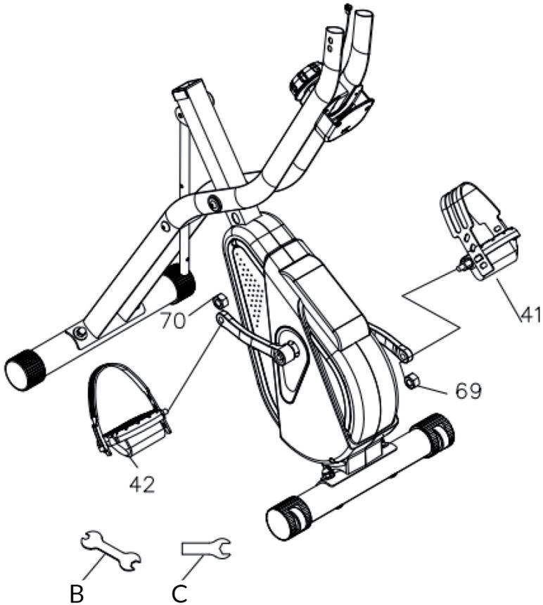
Verbinden Sie das linke Pedal (41) mit dem linken Kurbelarm und ziehen Sie es mit Werkzeug (B) fest, während Sie die Mutter (69) mit Werkzeug (C) festziehen.
