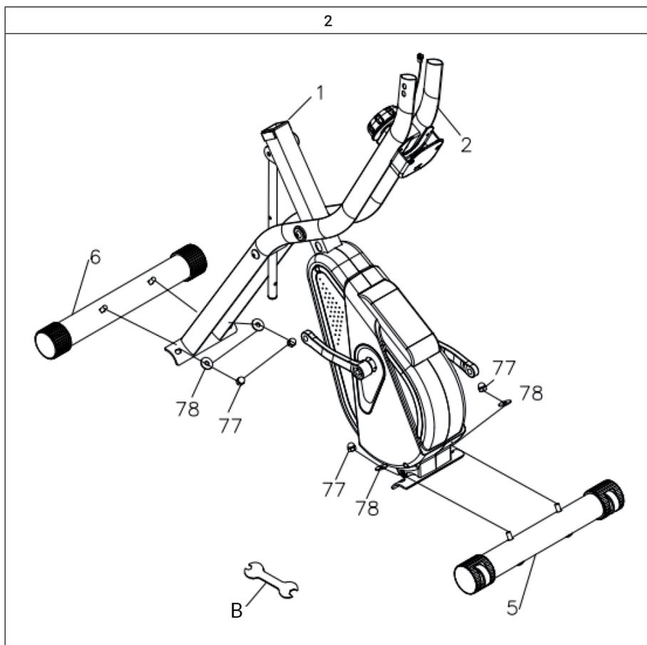
Fije la barra estabilizadora delantera (5) al cuadro principal (1) con 2 arandelas (78) y 2 tuercas (77). Use la herramienta (B) para esto.
