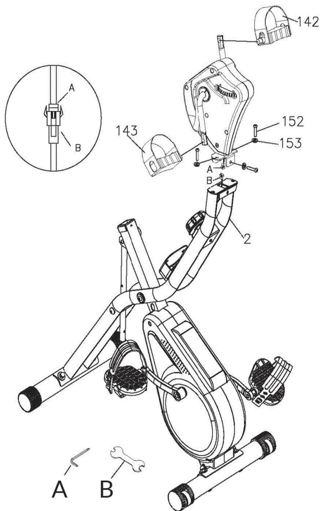
Conecte el enchufe del sensor A con el enchufe del sensor B.
