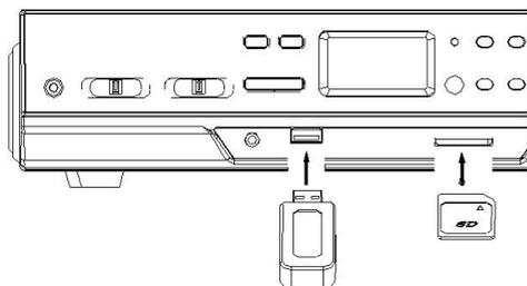
3. Selezionare con il tasto delle funzioni la modalità USB/SD. Se sono state inserite una chiavetta USB e una scheda SD, cambiare da modalità USB a SD con il tasto delle modalità. Dopo aver selezionato la modalità, inizia la lettura automatica del rispettivo supporto esterno e sullo schermo viene mostrata la quantità complessiva di cartelle e file MP3/WMA.
