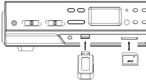
3. Utilisez la touche de fonction pour sélectionner le mode USB/SD. Si vous insérez une clé USB et une carte mémoire, appuyez sur la touche de mode pour basculer entre les modes USB et SD). Après avoir sélectionné le mode, le support de stockage sélectionné est lu automatiquement et le nombre total de dossiers et de fichiers MP3 / WMA s'affiche à l'écran.
