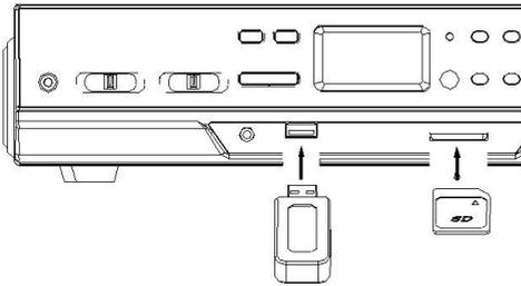
3. Seleccione el modo de USB/SD con el botón de función. Si se insertan tanto una unidad flash USB como una tarjeta de memoria, pulse el botón de modo para cambiar entre los modos USB y SD). Tras la selección del modo, el dispositivo de almacenamiento seleccionado se leerá automáticamente y el número total de carpetas y archivos MP3/WMA se mostrará en la pantalla.
