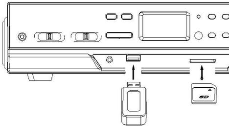
3. Wählen Sie mit der Funktionsauswahltaste den USB-/SD-Modus aus. Falls sowohl ein USB-Stick als auch eine Speicherkarte eingesteckt wurde, wechseln Sie durch Drücken der Modustaste zwischen dem USB- und dem SD-Modus). Nach der Modusauswahl wird das ausgewählte Speichermedium automatisch gelesen und die gesamte Anzahl von Ordnern und MP3/WMA-Dateien wird auf dem Bildschirm angezeigt.
