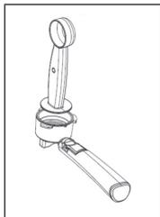
2. Coloque el embudo y fíjelo en la dirección de la flecha. A continuación, coloque la taza de café debajo del filtro.
