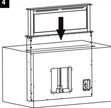
Introduzca la unidad de ventilación en el recorte y conéctela a la parte inferior de la encimera y a la carcasa a través de los rieles de sujeción.
