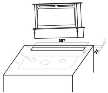
Predisporre il piano di lavoro con un'apertura per il piano cottura.
