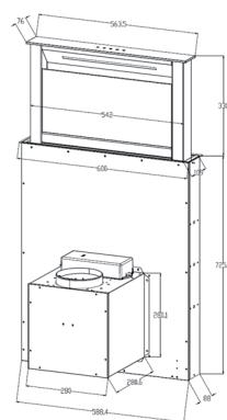
Dotar a la encimera de los recortes adecuados para el sistema de ventilación.
