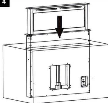
Setzen Sie die Lüftungsanlage in den Ausschnitt ein und verbinden Sie diese über die Halteschienen mit der Unterseite der Arbeitsplatte und dem Gehäuse.
