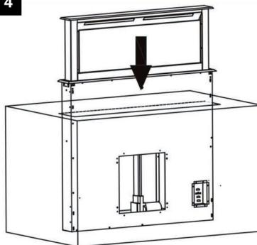
Inserire il sistema di ventilazione nell'apertura e collegarlo alla parte inferiore del piano di lavoro e all'alloggiamento tramite le guide di fissaggio.
