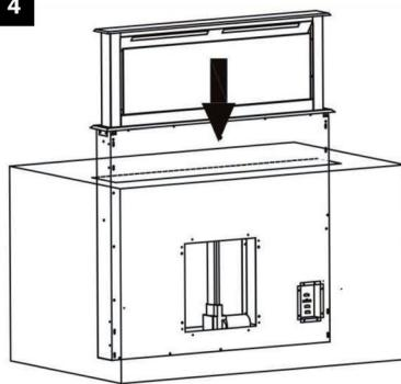
Insérez l'unité de ventilation dans la découpe et raccordez-la à la face inférieure du plan de travail et au boîtier à l'aide des rails de support.
