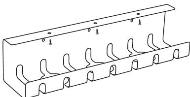
Utilisez une perceuse sans fil avec une mèche de Ø 3 mm et un tournevis cruciforme. Faites des pré percages pour éviter tout problème lors de l'installation.
