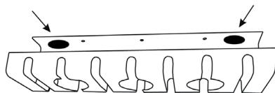
Localice las 2 almohadillas adhesivas rojas de doble cara en el interior de la bandeja portacables y retire la película protectora.
