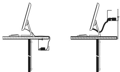
Installare la canalina su qualsiasi superficie verticale, su un divisorio della scrivania o direttamente sul muro (tasselli non inclusi!).
