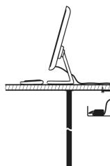
La canalina per cavi può essere fissata dal lato anteriore o posteriore, a seconda del tipo di scrivania. Usare la sagoma sul lato del cartone per praticare i fori.
