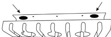
Suchen Sie die 2 roten doppelseitigen Klebeflächen im Inneren der Kabelwanne und entfernen Sie die Schutzfolie.
