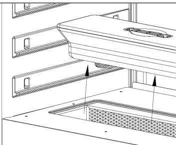
Après avoir retiré le couvercle, le réservoir d'eau devient visible. Sortez maintenant le réservoir d'eau de l'appareil dans le sens de la flèche.
