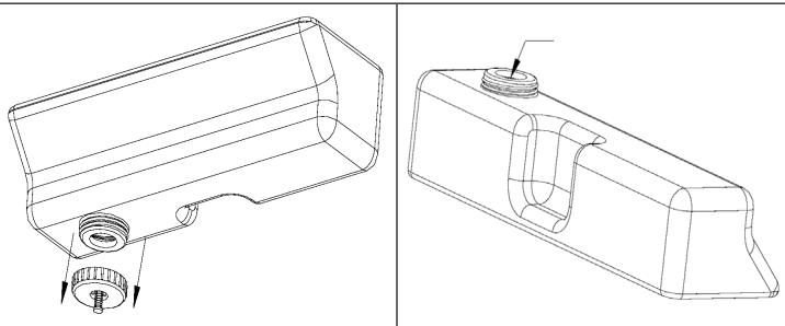
Ahora gira el tapón del fondo del tanque de agua y quitelo. Ahora puede llenar el tanque de agua con agua fresca. Luego cierre el tapón del tanque de agua y asegúrese de que está bien colocado.
