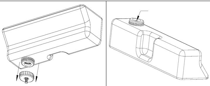
Tournez maintenant le bouchon sur réservoir d'eau et retirez-le. Vous pouvez maintenant remplir le réservoir d'eau avec de l'eau fraîche. Ensuite, vissez à nouveau le bouchon sur le réservoir d'eau et assurez-vous qu'il est correctement installé.
