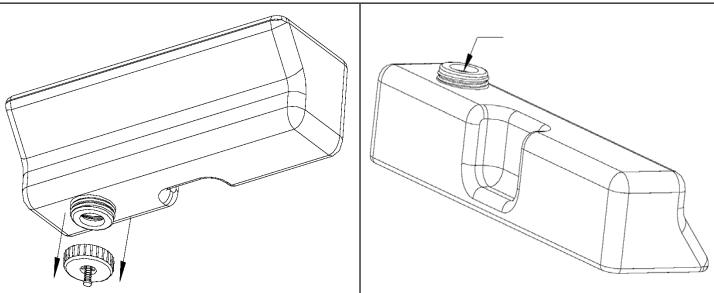
Girare e rimuovere il tappo che si trova sul lato inferiore del serbatoio. Ora è possibile riempire il serbatoio con acqua fresca. Richiudere il tappo del serbatoio assicurandosi che sia chiuso correttamente.
