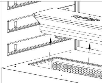
Al quitar la tapa del tanque de agua, se ve el tanque. Ahora retire el tanque de agua del aparato en la dirección de la flecha.
