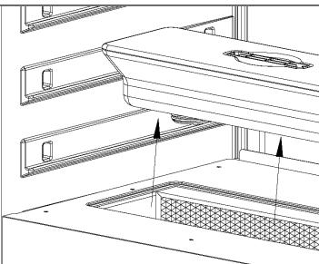
Quando si toglie la copertura, si vede il serbatoio. Togliere il serbatoio dal dispositivo seguendo la direzione delle frecce.
