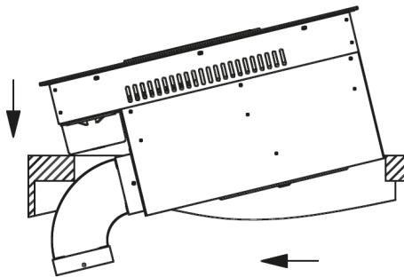
Soulevez la table de cuisson en biais et insérez-la dans le boîtier.
