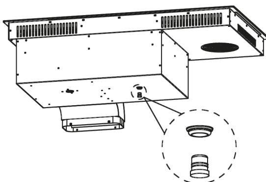
Öffnen Sie die wasserdichte Abdeckung.
