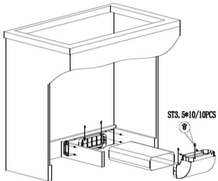
Befestigen Sie den Kohlefilter, das Kunststoffrohr und die Stützplatte.
