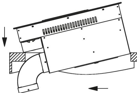
Sollevarе il piano cottura in posizione inclinata e farlo scorrere nell'alloggiamento.
