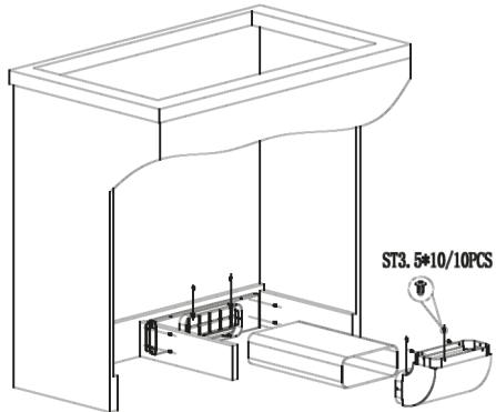
Fissare il filtro a carbone, il tubo di plastica e il pannello di supporto.
