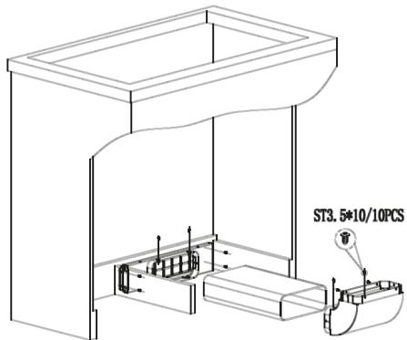
Coloque el filtro de carbón, el tubo de plástico y la placa de soporte.
