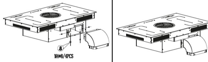
Befestigen Sie die Stützplatte.
