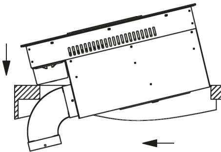
Levante la placa de cocción inclinándola y deslícela hacia la carcasa.
