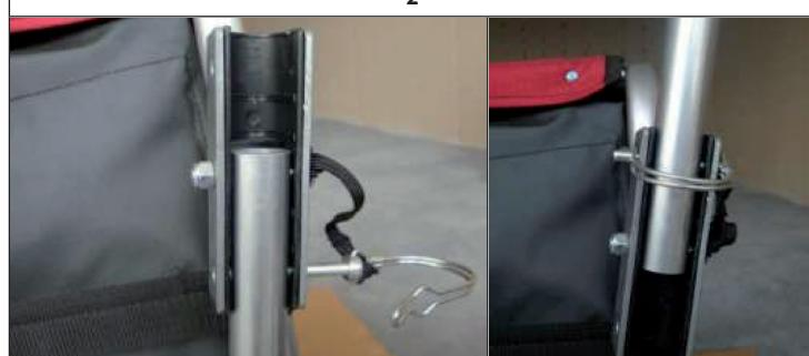
Levante el remolque. Retire el pasador de seguridad del orificio posterior. Gire el acoplamiento del remolque 180°. Vuelva a insertar el pasador de seguridad para bloquear el acoplamiento del remolque.
