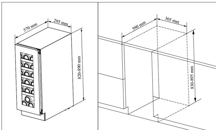
Diagrama de instalación para el modelo 10032038
