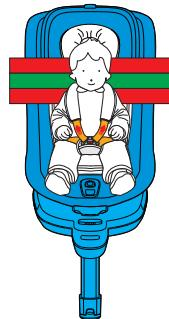
Si noti che un poggiapiede regolato correttamente garantisce una protezione ottimale per il bambino nel seggiolino; il poggiapiede deve essere regolato in modo che gli spallacci siano alla stessa altezza o leggermente al di sopra delle spalle del bambino.
