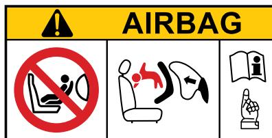
**Ne pas utiliser sur les sièges passagers avec airbags frontaux !**
