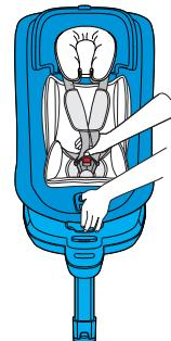
Abra la hebilla del cinturón de seguridad y coloque las correas de los hombros en los lados del asiento para mantener el cinturón abierto mientras coloca al niño.
