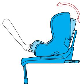
Für jüngere Kinder von 0 bis 6 Monaten verwenden Sie den Sitz in der am weitesten zurückgelehnten Position mit der Babyeinlage, um sicherzustellen, dass die Wirbelsäule Ihres Kindes beim Schlafen gestützt wird. Um die Position zu ändern, drücken Sie die Taste für die Neigungsverstellung und schieben oder ziehen Sie den Sitz in die gewünschte Position.
