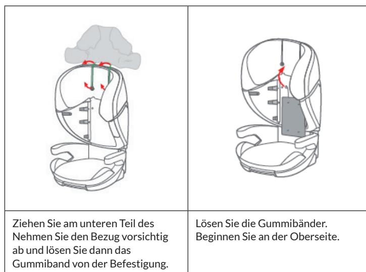
Ziehen Sie am unteren Teil des Neuhuts. Nehmen Sie den Bezug vorsichtig ab und lösen Sie dann das Gummiband von der Befestigung.
