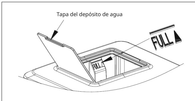
**Nota:** Nunca vierta agua en el depósito de agua interno, que se encuentra debajo de la cesta de hielo. Este tanque de agua no es lo suficientemente grande. La inobservancia puede afectar negativamente al proceso de fabricación de hielo.
