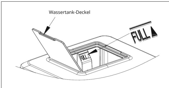
**Hinweis:** Schütten Sie keinesfalls Wasser in den internen Wassertank, welcher sich unterhalb des Eiskorbes befindet. Dieser Wassertank ist nicht groß genug. Nichtbeachtung kann den Eisherstellungsprozess negativ beeinflussen.
