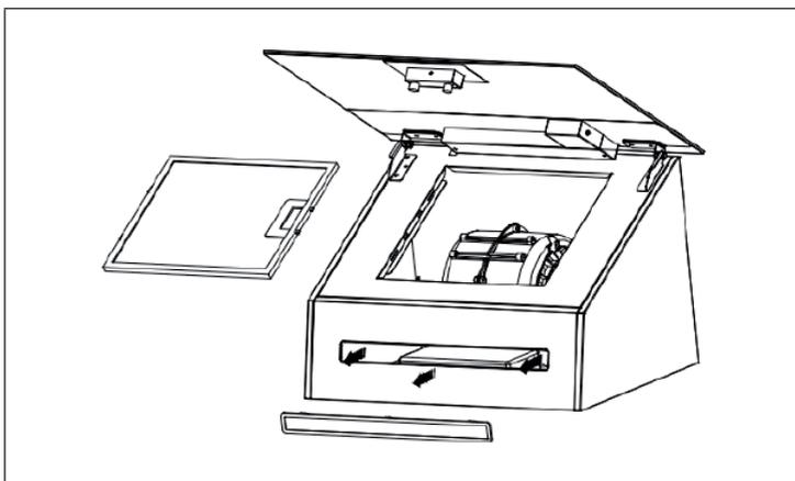
**Nota:** recuerde volver a colocar todo tras insertar la nueva bombilla y fijar los tornillos en la misma posición.
