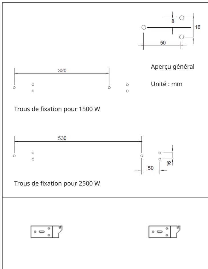
1. Fixez 2 supports sur la partie inférieure de l'appareil (voir image ci-dessous)
