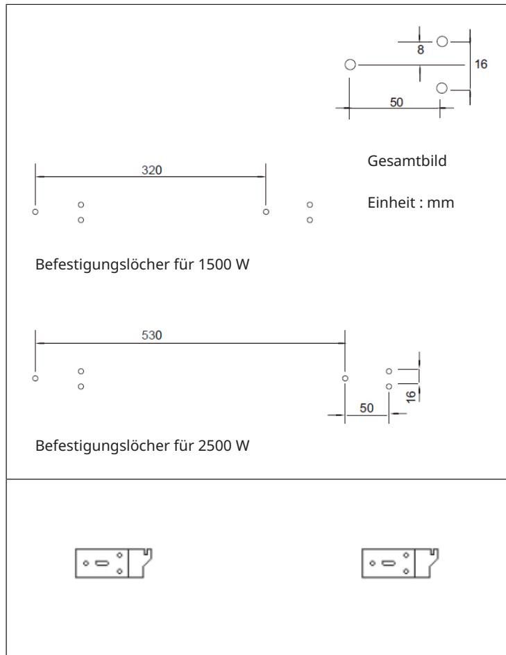
2. Befestigen Sie 2 Halterungen an der Unterseite des Geräts (siehe Bild unten)
