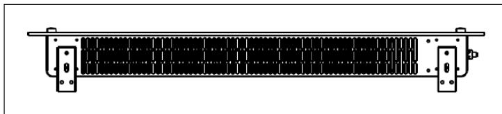
2. Tenere il dispositivo dai lati, fare attenzione alla posizione dei fori sul retro e posizionarlo sui supporti a muro. L'installazione a parete è completa (v. immagine sotto).
