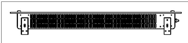
2. Tenez l'appareil par les côtés, faites attention à la position des perçages à l'arrière de l'appareil et placez l'appareil sur les supports muraux. L'installation murale est ainsi terminée (voir l'image ci-dessous).
