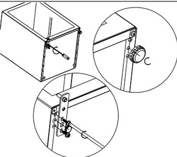
Montieren Sie die Aufhangung auf der gegenuberliegenden Seite. Setzen Sie die beiden verstellbaren FuÙe wieder ein.
