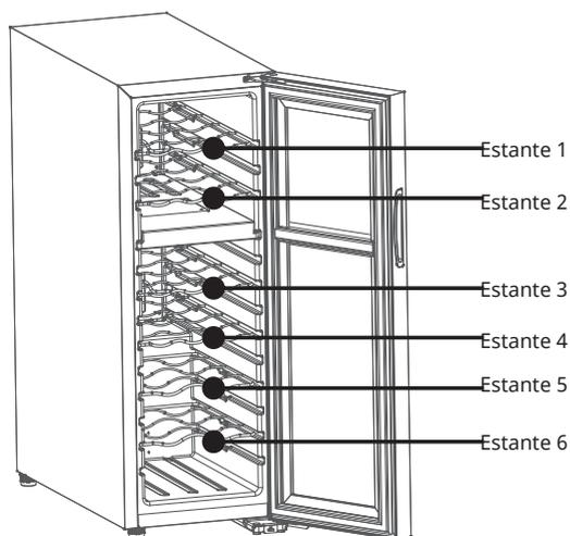
5-18 °C. Para la conservación del vino, se recomienda ajustar el aparato a 12 °C. Esta temperatura puede configurarse en función del tipo de vino almacenado. Si se configura la temperatura por encima de los 12 °C, se reducirá el consumo energético de la unidad. Si se configura la temperatura a menos de 12 °C, aumentará el consumo energético de la unidad.
