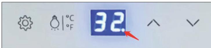
Wenn das Gerät eingeschaltet wird, blinkt die WLAN-Anzeige und zeigt an, dass die WLAN-Verbindung hergestellt werden kann.
