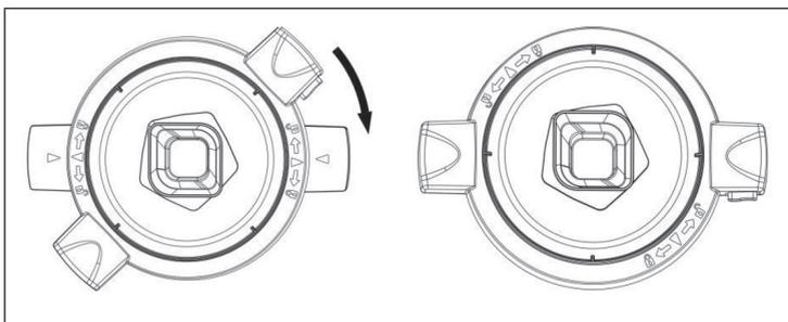
Um den Deckel abzunehmen, drücken Sie die Entriegelungstaste, drehen Sie den Deckel gegen den Uhrzeigersinn und ziehen Sie ihn dann gerade nach oben ab.
