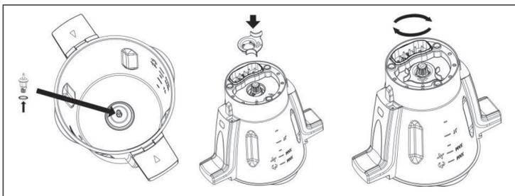
Baje el acoplamiento de motor desde la parte superior del bol de mezcla hacia abajo y a través del orificio hexagonal en la base del bol de mezcla.
