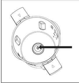
Nehmen Sie dazu die Antriebskupplung und vergewissern Sie sich, dass die Gummidichtung über der Unterseite der Kupplung angebracht ist, wie unten gezeigt. Wenn Sie die Gummidichtung nicht anbringen, können Flüssigkeiten aus dem Boden des Den Mixbehälters austreten.
