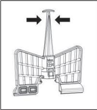
Para insertar el batidor, coloque la base del batidor sobre la parte superior de la cuchilla multifuncional y presione el batidor firmemente hacia abajo hasta que se acople. Para extraer el batidor, tire de él hacia arriba y hacia fuera.
