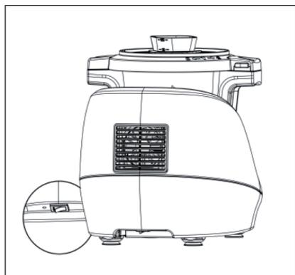
Sobald das Gerät eingeschaltet wird, ertönt ein Piepton und die Anzeige leuchtet auf.
