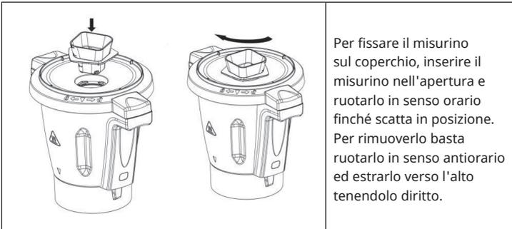
Per fissare il misurino sul coperchio, inserire il misurino nell'apertura e ruotarlo in senso orario finché scatta in posizione. Per rimuoverlo basta ruotarlo in senso antiorario ed estrarlo verso l'alto tenendolo diritto.
