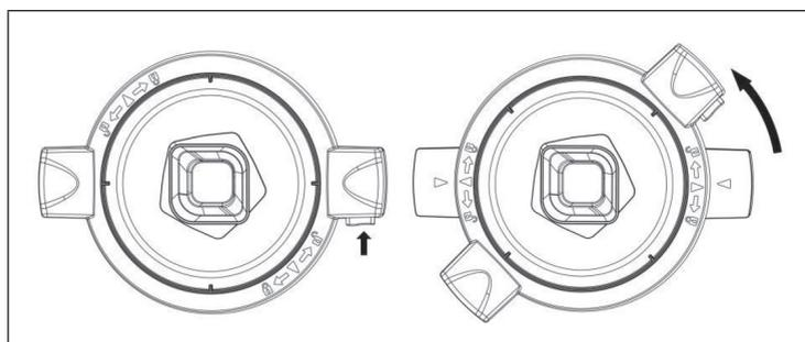
Placez le bol du mélangeur dans le bon sens sur la base de l'appareil.
