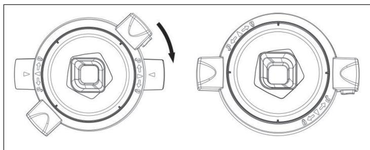
Pour retirer le couvercle, appuyez sur le bouton de déverrouillage, faites pivoter le couvercle dans le sens antihoraire, puis tirez vers le haut pour le retirer.
