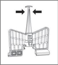
Um den Schneebeesen einzusetzen, richten Sie die Basis des Schneebeesen an der Oberseite des Multifunktionsmessers aus und drücken Sie den Schneebeesen fest nach unten, bis er einrastet. Um den Schneebeesen zu entfernen, ziehen Sie ihn gerade nach oben und heraus.
