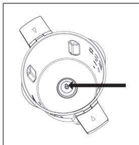
A tal fine prendere il giunto di trasmissione e assicurarsi che la guarnizione di gomma sia montata sopra la parte inferiore del giunto, come mostrato di seguito. Se non si monta la guarnizione di gomma, i liquidi possono fuoriuscire dalla base del recipiente del frullatore.
