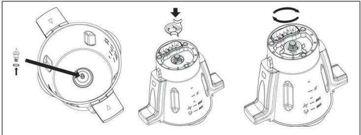
Senken Sie die Antriebskupplung von der Oberseite des Den Mixbehälters nach unten und durch das Sechskantloch im Boden des Den Mixbehälters.
