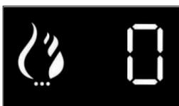
La potencia de calentamiento se muestra en pasos de 0 a 10. 10 es el ajuste más alto y significa que el aparato calienta más rápidamente.
