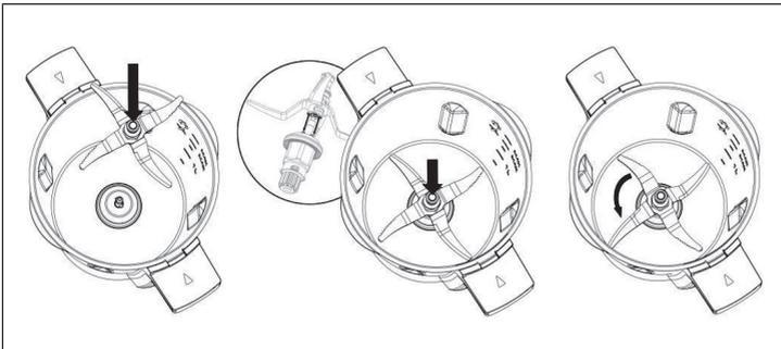
Gehen Sie zum Entfernen des Multifunktionsmessers wie folgt vor:
