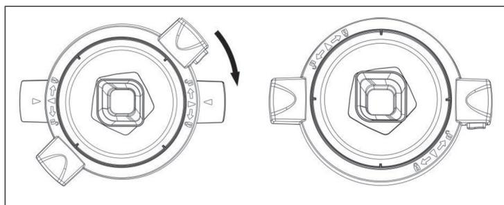
Per rimuovere il coperchio premere il tasto di rilascio, ruotare il coperchio in senso antiorario ed estrarlo verso l'alto tenendolo diritto.
