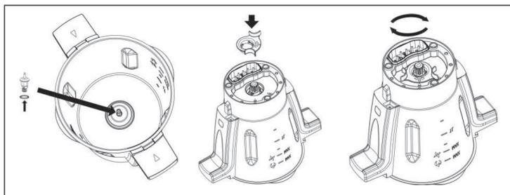
Abbassare il giunto di trasmissione dalla parte superiore del recipiente del frullatore e attraverso il foro esagonale nella parte inferiore del recipiente.
