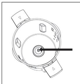
Pour ce faire, prenez le raccordement du moteur et assurez-vous que l'œillet en caoutchouc est en place sur le bas du coupleur, comme indiqué ci-dessous. Si vous ne fixez pas le joint en caoutchouc, des liquides peuvent fuir du fond du bol mixeur.
