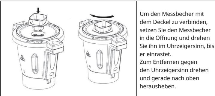
Um den Messbecher mit dem Deckel zu verbinden, setzen Sie den Messbecher in die Öffnung und drehen Sie ihn im Uhrzeigersinn, bis er einrastet. Zum Entfernen gegen den Uhrzeigersinn drehen und gerade nach oben herausheben.
