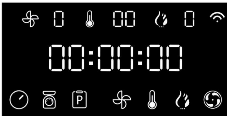
**Nota:** tutte le funzioni possono essere utilizzate solo se si installa il recipiente del frullatore e il coperchio è posizionato e bloccato. In caso contrario sono attive solo la bilancia e la funzione riscaldante. Se il coperchio non è posizionato, il riscaldamento non si aziona. Il motore funziona solo se il coperchio è posizionato e bloccato.
