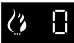
La puissance de chauffe est affichée par pas de 0 à 10. 10 est le réglage le plus élevé et signifie que l'appareil chauffe plus rapidement.
