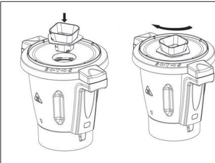
Para instalar el vaso medidor en la tapa, colóquelo en el agujero y gírelo en el sentido de las agujas del reloj hasta que se acople.
