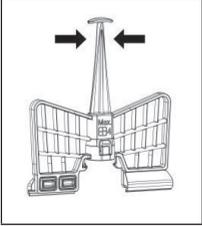
Pour insérer le fouet, alignez sa base avec le haut de la lame multifonction et appuyez fermement sur le fouet jusqu'à ce qu'il s'enclenche. Pour retirer le fouet, tirez droit vers le haut.
