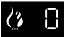
Die Heizleistung wird in Stufen von 0 bis 10 angezeigt. 10 ist die höchste Einstellung und bedeutet, dass das Gerät schneller heizt.
