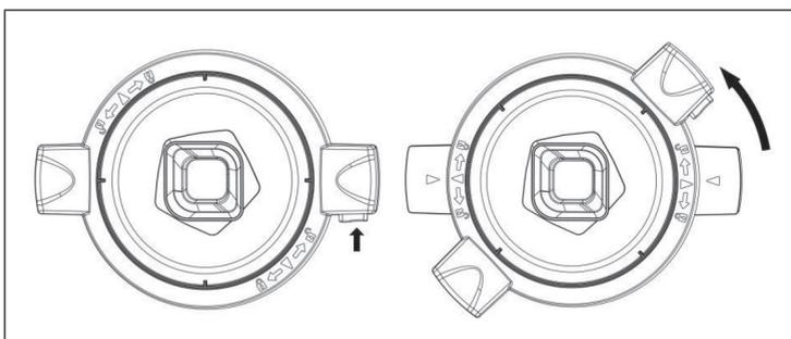
Setzen Sie den Mixbehälter in der richtigen Ausrichtung auf das Basisgerät.
