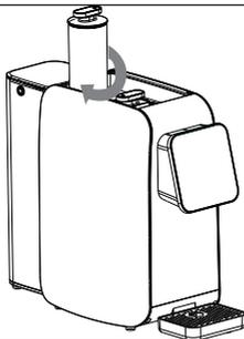
Setzen Sie das neue Filterelement ein und drehen Sie es im Uhrzeigersinn, um es leichter zu machen.
