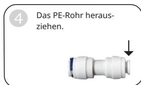
**INSTALLATION DER FILTERKARTUSCHE**
