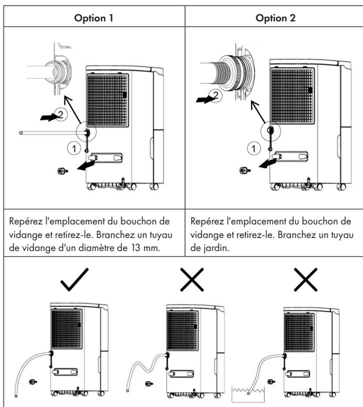
**Remarque :** La conduite d'évacuation ne doit pas être trop longue (une longueur inférieure à 60 cm est recommandée). L'extrémité de la conduite de vidange doit être plus basse que la sortie d'eau (au moins 10 cm plus bas), sinon il y a un risque de fuite.
