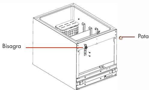
Instale la bisagra inferior y la pata ajustable en el lado inferior izquierdo del armario o en el lado inferior derecho.
