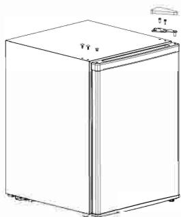
Smontare i tappi dei fori, la copertura della cerniera superiore, le viti di fissaggio della cerniera superiore e staccare poi la cerniera. Tenere in verticale lo sportello durante tutto il procedimento per evitare che cada.
