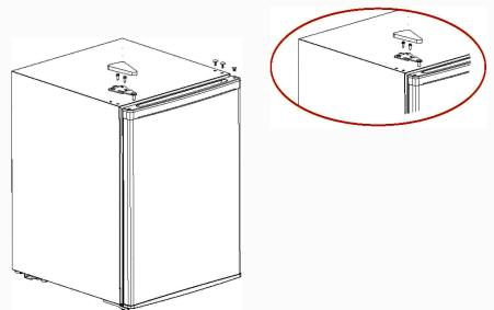
Coloque la puerta sobre la bisagra inferior y compruebe la estanqueidad de la junta. A continuación, instale la bisagra superior montando los tornillos y la tapa de la bisagra y coloque finalmente los embellecedores de la parte superior derecha.
