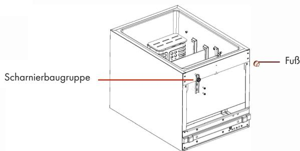
Installieren Sie das untere Scharnier und den einstellbaren Fuß an der linken unteren Seite des Schranks bzw. an der rechten unteren Seite.
