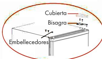
Desmonte los embellecedores, la cubierta superior de la bisagra, los tornillos de fijación de la bisagra superior y desmonte la bisagra superior. Mantenga la puerta en estado vertical durante todo el proceso para evitar que se caiga.
