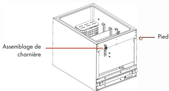
Installez la charnière inférieure et le pied réglable sur le côté inférieur gauche du réfrigérateur ou sur le côté inférieur droit.
