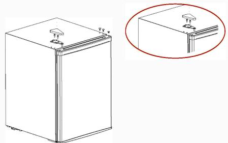
Placez la porte verticalement sur la charnière inférieure et vérifiez que le joint de la porte ne fuit pas. Ensuite, installez la charnière supérieure en assemblant les vis et le cache de la charnière, et enfin couvrez les trous de capuchons sur le côté supérieur droit.
