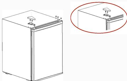
Posizionare lo sportello in verticale sulla cerniera inferiore e controllare se la guarnizione dello sportello tiene. Installare poi la cerniera superiore montando le viti e la copertura della cerniera e coprire poi i fori con i tappi sul lato superiore destro.
