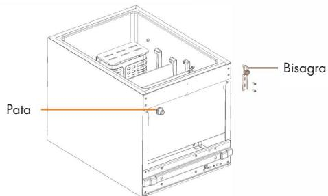
Desmonte la bisagra inferior y la pata ajustable.
