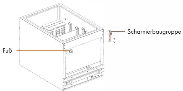
Demontieren Sie die untere Scharnierbaugruppe und den einstellbaren Fuß.
