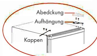
Demonstrieren Sie die Lochkappen, die obere Scharnierabdeckung, die Befestigungsschrauben des oberen Scharniers und entfernen Sie das obere Scharnier. Bitte halten Sie die Tür während des gesamten Vorgangs senkrecht, um ein Herunterfallen zu vermeiden.
