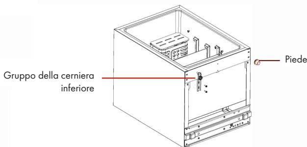
Installare la cerniera inferiore e il piede regolabile sul lato inferiore sinistro del dispositivo o su quello destro.
