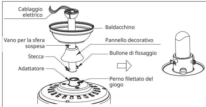
Per estendere la lunghezza del gancio di fissaggio del ventilatore, è necessario rimuovere la sfera di fissaggio dall'asta da 6 pollici in dotazione, in modo da poter utilizzare un'asta più lunga (inclusa in consegna) (se si desidera utilizzare l'asta da 6 pollici, proseguire con le istruzioni seguenti).
