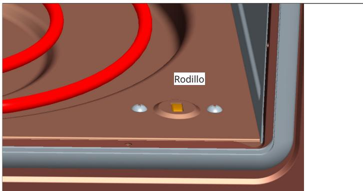
Como se muestra en la ilustración anterior, hay una rueda a la izquierda y a la derecha en la zona delantera de la cámara de cocción. La piedra para pizza se coloca primero sobre estas ruedas y, a continuación, se introduce simplemente en el interior de la cámara de cocción. Este detalle constituye la estructura única y novedosa de este producto. De este modo, puede colocar sin problemas en la cámara de cocción incluso piedras de pizza más pesadas
