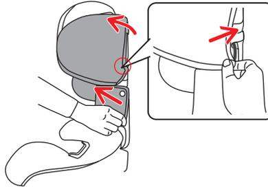
Entfernen Sie die Abdeckung der Sitzbasis: Entfernen Sie den Becherhalter. Ziehen Sie dann die Abdeckung von unten nach oben heraus.
