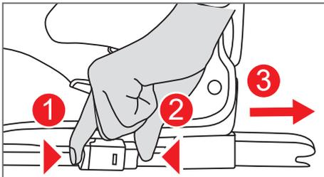
Stecken Sie beide ISOFIX-Steckverbindungen in die ISOFIX-Verankerungspunkte, bis Sie ein deutliches Klicken hören und die Anzeige des ISOFIX-Steckers grün ist. Schieben Sie dann den Kindersitz in die Rückenlehne des Fahrzeugs, bis er fest sitzt.
