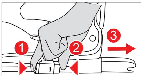
Inserire entrambi i connettori a innesto ISOFIX nei punti di ancoraggio ISOFIX finché non si sente uno scatto netto e l'indicatore del connettore ISOFIX è verde. Spingere quindi il seggiolino nello schienale del veicolo fino a quando non è saldamente in posizione.
