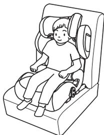
3. Ziehen Sie den Sicherheitsgurt des Fahrzeugs, führen Sie den Schultergurt durch den Führungshaken der Kopfstütze und den Beckengurt durch die Führungshaken des Beckengurts rechts und links. Führen Sie die Zunge in das Fahrzeugschloss ein, bis Sie ein deutliches Klicken hören.
