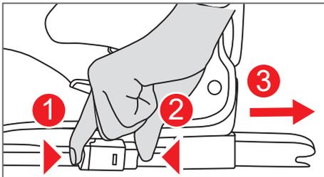
Inserte ambos conectores ISOFIX en los puntos de anclaje ISOFIX hasta que oiga un clic claro y el indicador del conector ISOFIX esté en verde. A continuación, introduzca el asiento infantil en el respaldo del vehículo hasta que quede firmemente sujeto.
