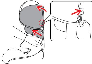
Retire la cubierta de la base del asiento: Retire el portavasos. A continuación, tire de la tapa desde abajo hacia arriba.
