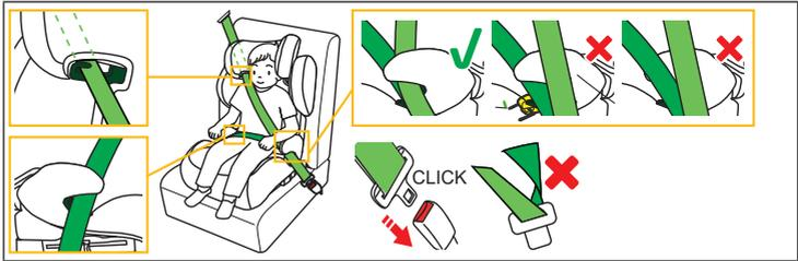
**¡ATENCIÓN!** No se permite la holgura y torsión del cinturón del vehículo durante la instalación.
