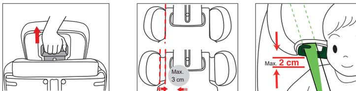
**Installazione di un seggiolino per bambini con cintura di sicurezza a 3 punti/
