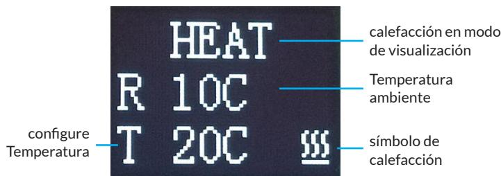
**Calefacción modo normalmente abierto** Pulse brevemente el botón ON/OFF para encender el aparato y entrar en el modo de calefacción normal.
