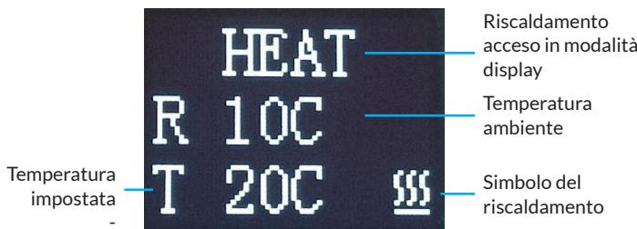
Utilizzare i tasti ▼ e ▲ per impostare la temperatura impostata. Premere brevemente ▼ e ▲ per aumentare o diminuire la temperatura. Dopo 8 secondi il dispositivo salverà automaticamente l'impostazione se non vengono premuti altri tasti.
