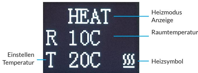
**Normaler offener Heizmodus** Drücken Sie kurz die ON/OFF-Taste, um das Gerät einzuschalten und in den normalen Heizmodus zu gelangen.
