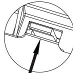
Placez le filtre à charbon dans la fente, appuyez avec le doigt dans le sens de la flèche pour fixer la position de la boucle.
