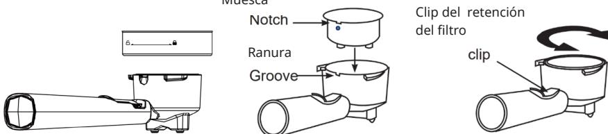
3. Coloque una mano sobre la cafetera espresso para apoyarla y fije el portafiltro sujetándolo por el mango e introduciéndolo en la cafetera como se muestra a continuación. Luego gírello en el sentido de las agujas del reloj hasta la posición de bloqueo como se muestra a continuación.
