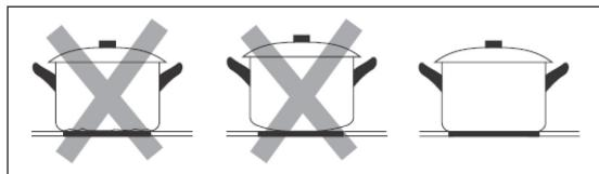
Assicurarsi che la base della pentola sia liscia, appoggiata al vetro e della stessa dimensione della zona di cottura. Utilizzare pentole il cui diametro sia pari al grafico della zona selezionata. Utilizzando una pentola un po' più larga l'energia verrà utilizzata con la massima efficienza. Se si utilizzano pentole più piccole, l'efficienza potrebbe essere inferiore a quella prevista. Un tegame più piccolo di 140 mm potrebbe non essere rilevato dal piano di cottura. Posizionare sempre la
