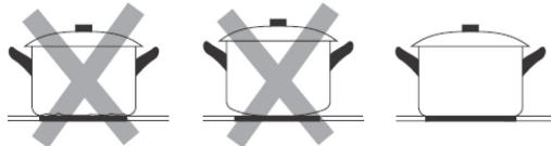
No son adecuados los utensilios de cocina fabricados con los siguientes materiales: acero inoxidable puro, aluminio o cobre sin base magnética, vidrio, madera, porcelana, cerámica y loza. No utilice utensilios de cocina con bordes afilados o fondo redondeado.
