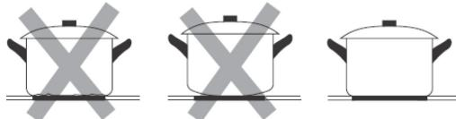
Les ustensiles de cuisine fabriqués à partir des matériaux suivants ne conviennent pas : acier inoxydable pur, aluminium ou cuivre sans face inférieure magnétique, verre, bois, porcelaine, céramique et poterie. N'utilisez pas d'ustensiles de cuisine ayant des bords tranchants ou un fond arrondi.
