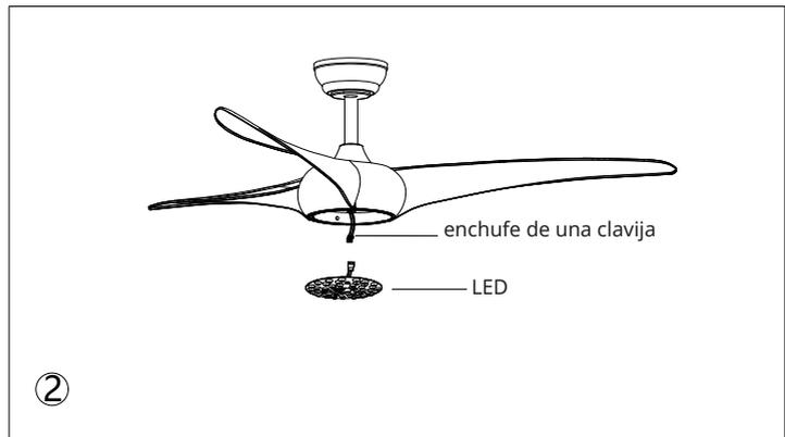
Vuelva a colocar la cubierta y la pantalla de la lámpara en la bandeja de LED.
