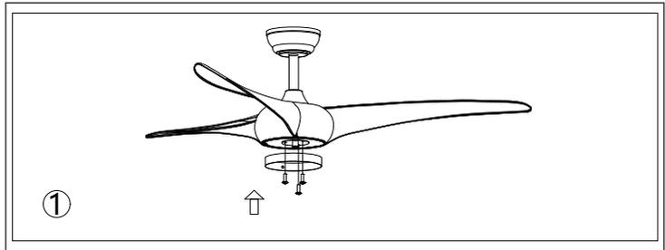
Entfernen Sie die drei Schrauben an der Motoranschlussplatte. Ordnen Sie alle Drähte im Inneren der Anschlussplatte sorgfältig an. Richten Sie die Löcher auf der Rückseite der LED-Leuchte mit den drei Schrauben auf der Motoranschlussplatte aus (siehe Abb. 1) und ziehen Sie die drei Schrauben vom Loch auf der LED-Platte aus an. Achten Sie darauf, dass sich das Beleuchtungs-Set nach dem Anschrauben nicht mehr bewegen lässt.
