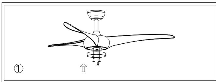
Retirez les trois vis de la plaque de connexion du moteur. Rangez soigneusement tous les fils à l'intérieur de la plaque de connexion. Assemblez et alignez les trous à l'arrière de la lumière LED avec les trois vis sur la plaque de connexion du moteur (voir Fig.1), puis serrez les trois vis du trou sur la plaque LED. Assurez-vous que le kit d'éclairage ne bouge pas après le vissage.
