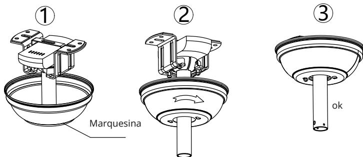
Levante la capota hasta el soporte de suspensión, alineando los tornillos aflojados del soporte de suspensión con los orificios ranurados de la capota. Gire la capota para bloquearla. Vuelva a insertar los tornillos y asegure todos los tornillos con un destornillador.
