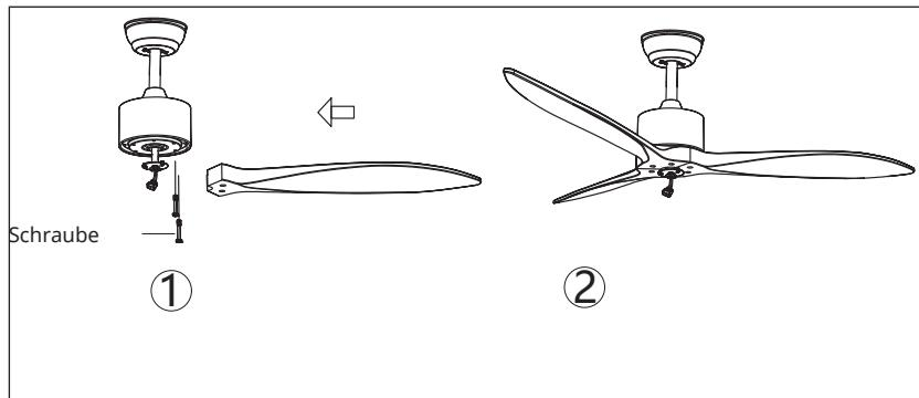
**Zeitersparnis:** Die Unterlegscheiben für die Rotorblattschrauben können an jeder Rotorblattschraube angebracht werden, bevor die Rotorblätter angebracht werden.
