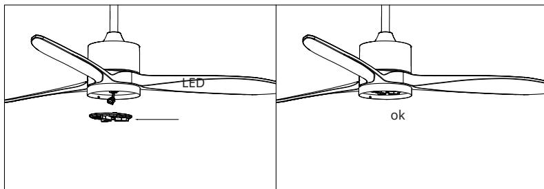
Recolocar la cubierta y la pantalla de lámpara en el panel LED
