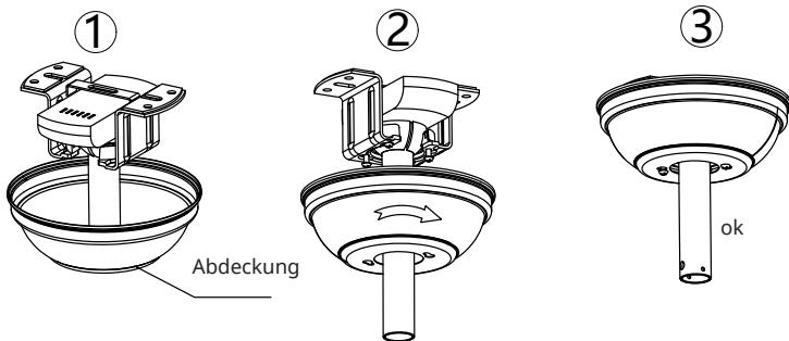
Heben Sie die Abdeckung bis zur Aufhängung an und richten Sie dabei die gelösten Schrauben in der Aufhängung an den Langlöchern in der Abdeckung aus. Drehen Sie die Kabinenhaube zum Verriegeln. Setzen Sie die Schrauben wieder ein und sichern Sie alle Schrauben mit einem Schraubendreher.
