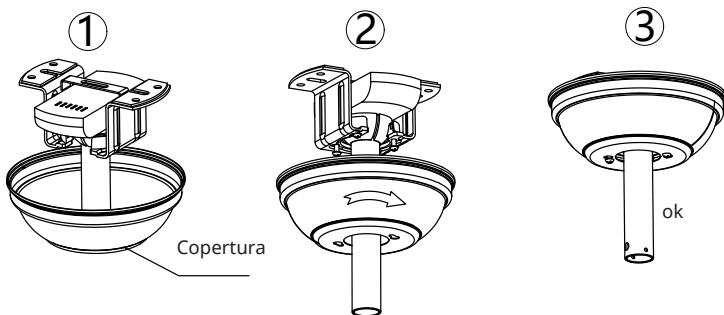
Sollevi il tettuccio fino alla staffa di aggancio, allineando le viti allentate della staffa di aggancio con i fori scanalati del tettuccio. Giri il tettuccio per bloccarlo. Reinserta le viti e fissi tutte le viti con un cacciavite.
