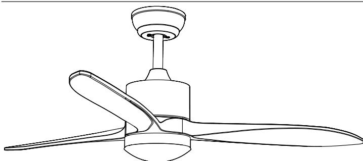
Bringen Sie die Abdeckung und den Lampenschirm wieder am LED-Rahmen an und befestigen Sie sie mit Zierklammern und Schraubenmuttern.
