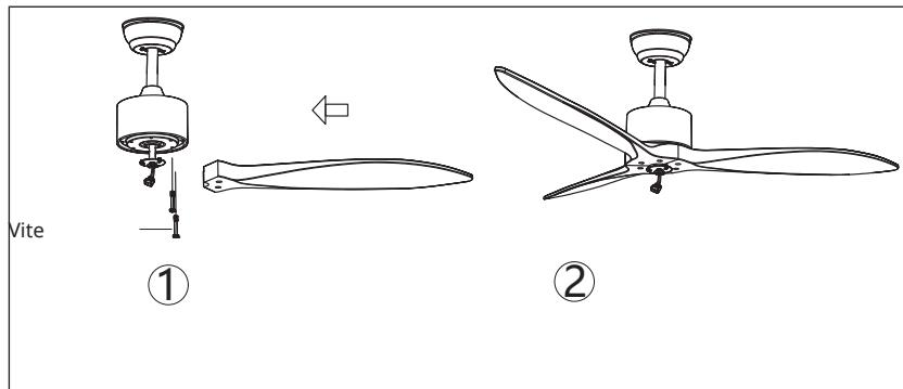
**Risparmio di tempo:** Le rondelle per le viti delle lame possono essere montate su ogni vite della lama prima di montare le lame.
