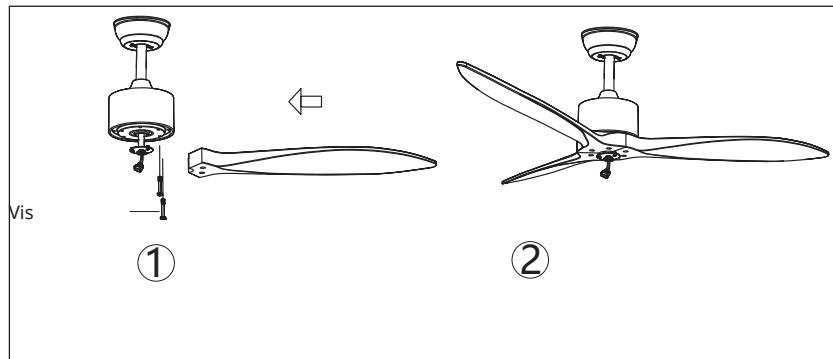
**Gain de temps:** Les rondelles pour les vis de pales peuvent être montées sur chaque vis de lame avant que les pales ne soient montées.
