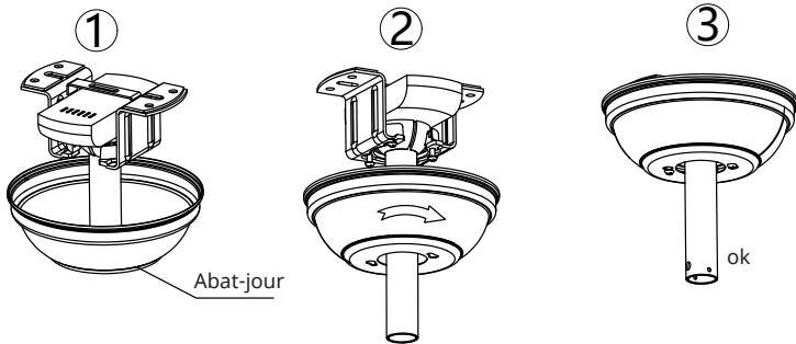
Soulevez l'auvent jusqu'au support de suspension, en alignant les vis desserrées du support de suspension sur les trous oblongs de l'auvent. Tournez l'auvent pour le verrouiller. Réinsérez les vis et fixez-les à l'aide d'un tournevis.
