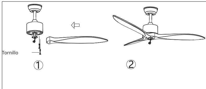
**Ahorro de tiempo:** Las arandelas para los tornillos de las cuchillas pueden colocarse en cada tornillo de las cuchillas antes de montarlas.
