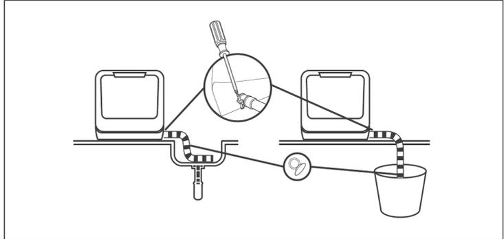
Insérez l'extrémité du tuyau de vidange dans un évier ou un seau. Fixez le tuyau de vidange avec des ventouses.
