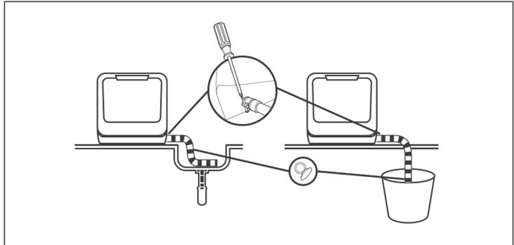
Encaje el extremo del tubo de desagüe a un fregadero o a un cubo. Fije el tubo de desagüe con ventosas.
