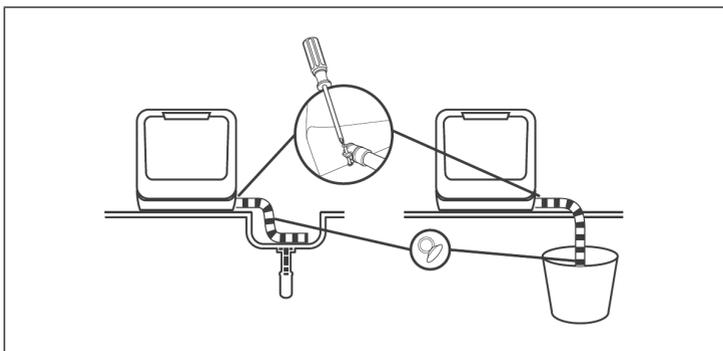
Inserire l'estremità del tubo di scarico in un lavandino o in un secchio. Fissare il tubo di drenaggio con delle ventose.
