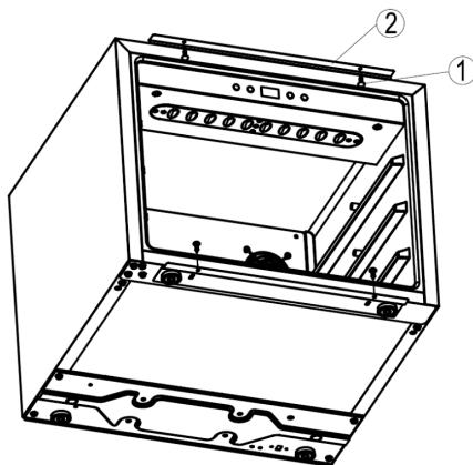
Das Gerät ist oben (②) und unten mit einem Paar Halterungen ausgestattet. Dieses Paar Halterungen wird möglicherweise nicht benötigt und kann je nach Ihrer tatsächlichen Einbausituation entfernt werden, wenn Sie das Gerät in Ihren Schrank einbauen..
