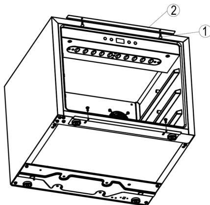
Il dispositivo è dotato di una coppia di supporti nella parte superiore(②) e inferiore.
