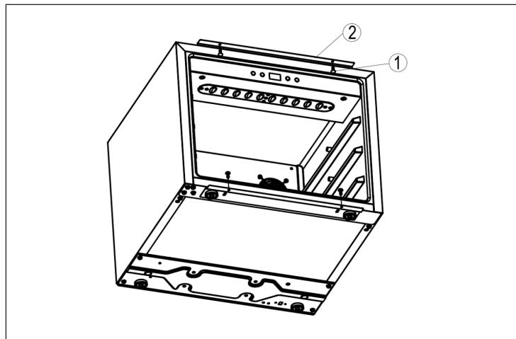
L'appareil est équipé d'une paire de supports en haut(②) et en bas.
