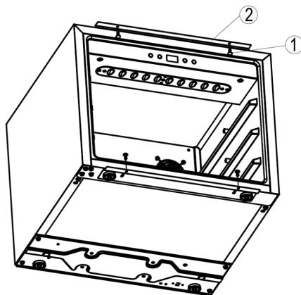
El aparato está provisto de un par de soportes en la parte superior (②) e inferior. Es posible que este par de soportes no sean necesarios y pueden retirarse dependiendo de su situación real de instalación cuando instale el aparato en su armario.
