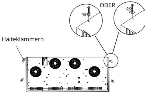
Befestigen Sie das Kochfeld nach dem Einbau an der Arbeitsplatte, indem Sie die 4 Halterungen an der Unterseite des Kochfelds anschrauben (siehe Abbildung).
