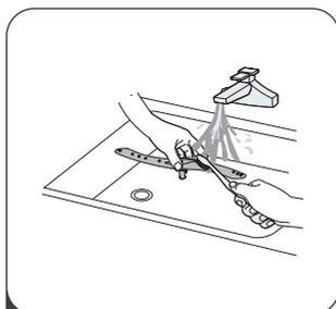
3 Legen Sie die Sprüharme in eine Seifenlösung mit warmem Wasser und verwenden Sie zur Reinigung der Düsen eine weiche Bürste.
