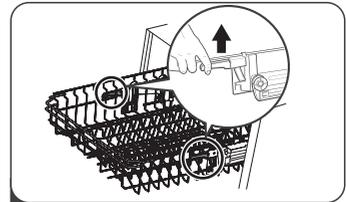
2 Im Absenken des oberen Korbs heben Sie die Verstellgriffe auf beiden Seiten an, um den Korb zu entriegeln und ihn in die untere Position zu bringen.
