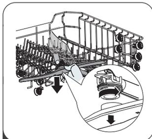
1 Um den oberen Sprüharm zu entfernen, halten Sie die Mutter in der Mitte fest und drehen Sie den Sprüharm gegen den Uhrzeigersinn, um ihn zu entfernen.
