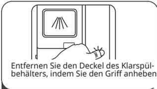
Entfernen Sie den Deckel des Klarspülbehälters, indem Sie den Griff anheben.
