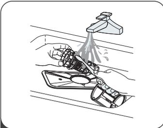
3 Größere Lebensmittelreste können entfernt werden, indem der Filter unter fließendem Wasser abgespült wird. Verwenden Sie für eine gründlichere Reinigung eine weiche Bürste.
