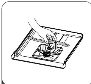
2 Ziehen Sie den Sprüharm nach oben, damit Sie den unteren Sprüharm entnehmen können.
