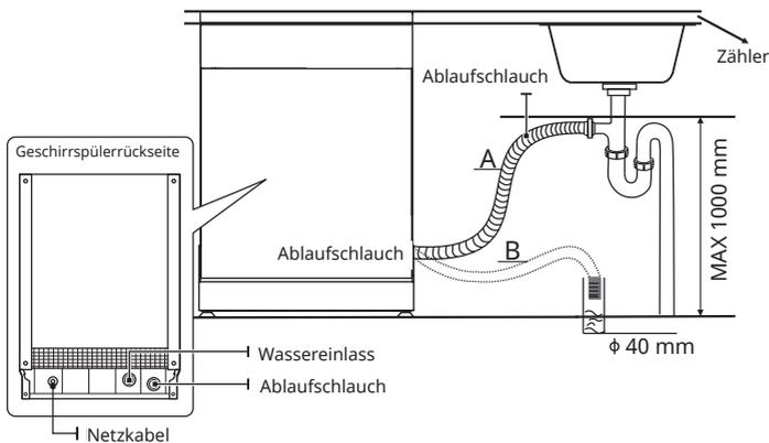
**Hinweis:** Befestigen Sie den Ablaufschlauch entweder in Position A oder in Position B
