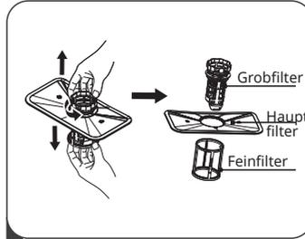
2 Der Feinfilter kann von der Unterseite der Filtereinheit entfernt werden. Der Grobfilter kann vom Hauptfilter abgenommen werden, indem Sie die Laschen oben leicht zusammendrücken und ihn abziehen. Halten Sie den Grobfilter und drehen Sie ihn 2 Mal gegen den Uhrzeigersinn, um den Filter zu entriegeln. Heben Sie den Filter nach oben und aus dem Geschirrspüler heraus.
