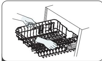
1 Um den oberen Korb anzuheben, heben Sie den oberen Korb einfach in der Mitte jeder Seite an, bis er in der oberen Position einrastet. Es ist nicht notwendig, den Verstellgriff anzuheben.
