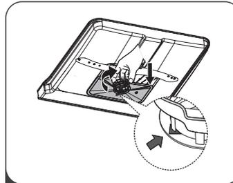
4 Bauen Sie die Filter in umgekehrter Reihenfolge des Ausbaus wieder ein, indem Sie das Filterelement wieder einsetzen und im Uhrzeigersinn bis zum Schließpfeil drehen.
