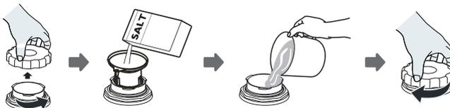
1. Entfernen Sie den unteren Korb und schrauben Sie den Deckel ab.
