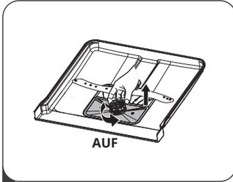
1 Halten Sie den Grobfilter fest und drehen Sie diesen zum Lösen gegen den Uhrzeigersinn. Heben Sie den Filter nach oben und aus dem Geschirrspüler heraus.
