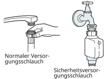
**Hinweis:** Soll das Gerät an die Trinkwasserversorgung angeschlossen werden, muss es mit einer Sicherheitseinrichtung gegen die Verunreinigung des Trinkwassers durch Rückfließen (nach DIN EN 1717) ausgestattet sein. Wir empfehlen, dass die Installation, einschließlich der Wasser- und Elektroanschlüsse, sowie Reparaturen von einem qualifizierten Fachmann durchgeführt werden.
