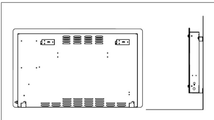
**Nota:** Antes de perforar, asegúrese de que no hay cables o tuberías en la pared para evitar daños. Asegúrese de que los tornillos estén bien apretados y asegurados en la pared para garantizar una instalación segura del calefactor en la pared. Respete la distancia de seguridad indicada a continuación.
