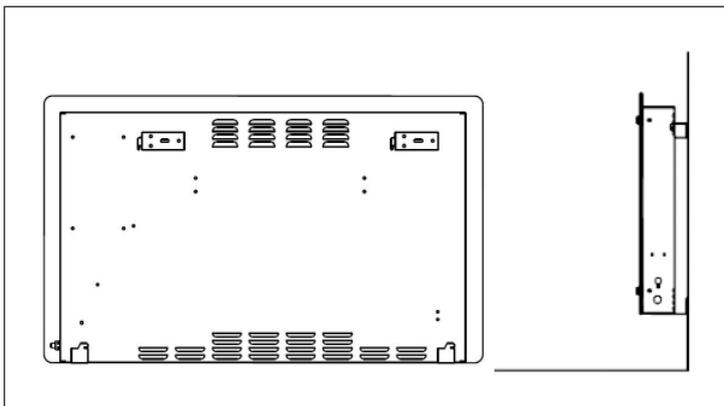
**Nota:** prima di realizzare i fori, assicurarsi che non ci siano cavi o tubi nel muro per evitare danni. Assicurarsi che le viti siano saldamente posizionate nella parete per garantire un'installazione sicura. Si prega di rispettare la distanza di sicurezza indicata di seguito.
