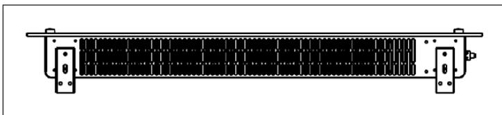
3. Tenere il dispositivo dai lati, fare attenzione alla posizione dei fori sul retro e posizionarlo sui supporti a muro. L'installazione a parete è completa (v. immagine sotto).
