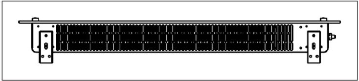
3. Halten Sie das Gerät an den Seiten fest, achten Sie auf die Position der Bohrungen auf der Geräterückseite und setzen Sie das Gerät auf die Wandhalterungen. Damit ist die Wandinstallation abgeschlossen (siehe Bild unten).
