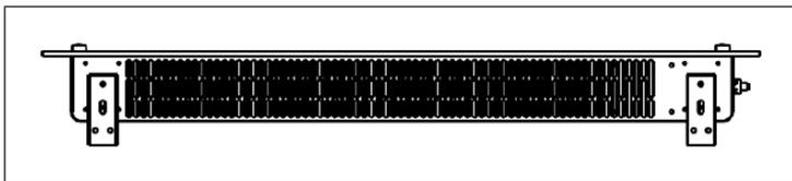
3. Sostenga la unidad por los lados, preste atención a la posición de los agujeros en la parte posterior de la unidad y coloque la unidad en los soportes de pared. Así se completa la instalación en la pared (véase la imagen inferior).
