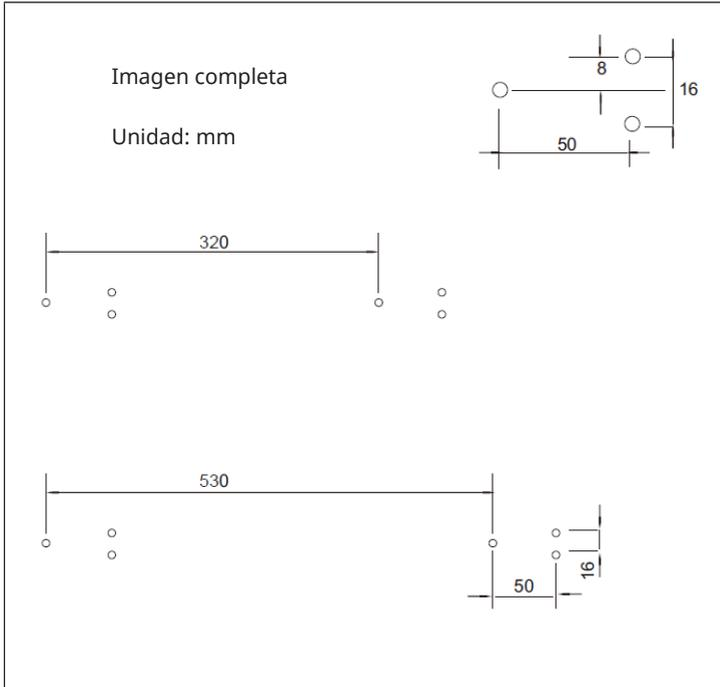
2. Coloque 2 soportes en la parte inferior de la unidad (véase la imagen de abajo).
