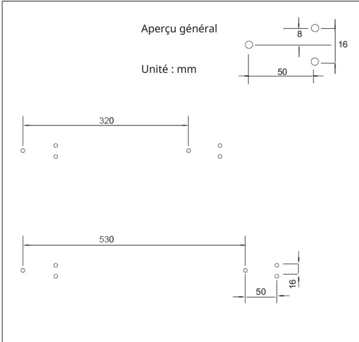
2. Fixez 2 supports sur la partie inférieure de l'appareil (voir image ci-dessous).
