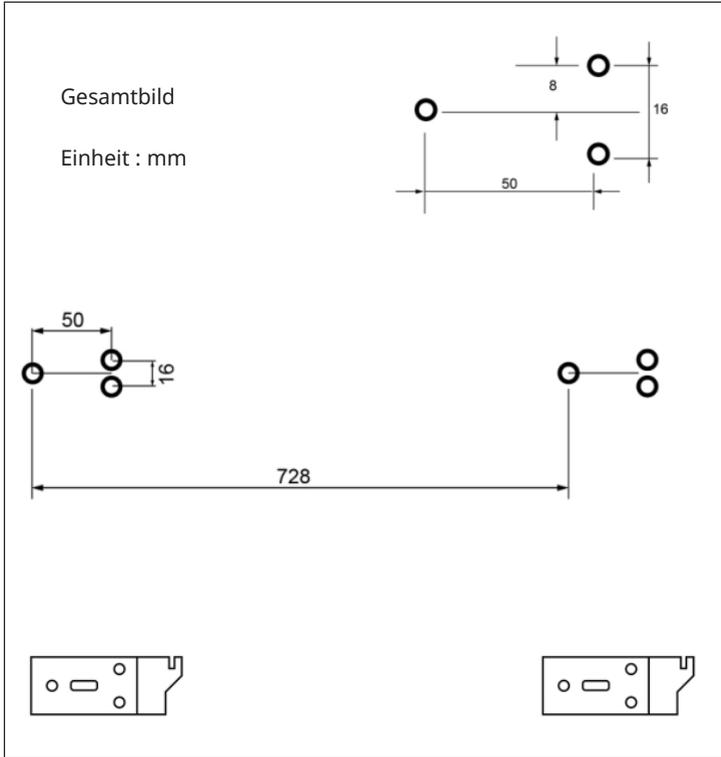
2. Befestigen Sie 2 Halterungen an der Unterseite des Geräts (siehe Bild unten).
