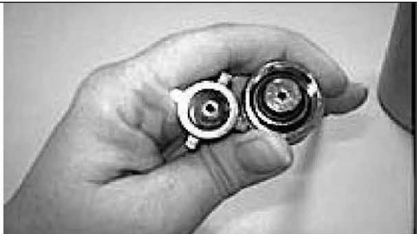
O-Ringe an der CO2-Leitung
