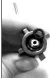
Conduite de CO 2 vers le manomètre
