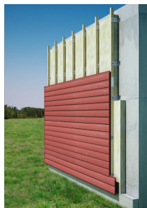
Mise en place d'un pare-pluie
