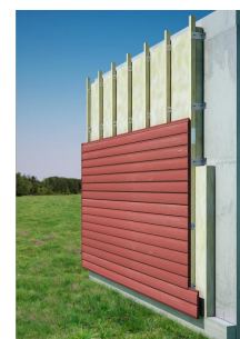
Mise en place d'un pare-pluie
