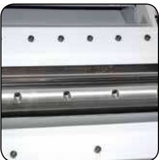
Arbre de dégauchissage de \varnothing 70 mm avec 3 fers 310x 25x 3 Schaafas met \varnothing 70 mm en met 3 messen 310 x 25 x 3
