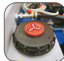
Couvercle avec soupape de surpression et d'aération
