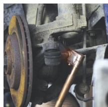
Dégrillage de biellettes
