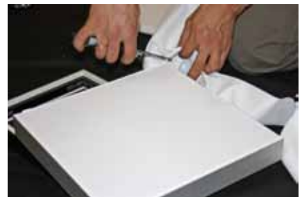
6. Gewebbahn vollständig nachschneiden, einen Überstand lassen
