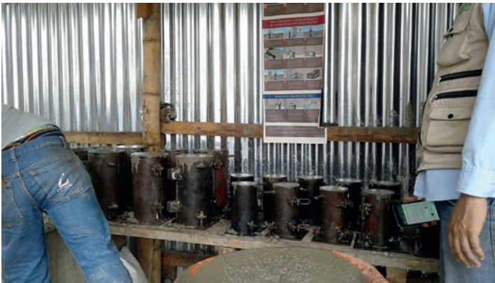
Foto 3: Muestras para las pruebas de resistencia del concreto.
