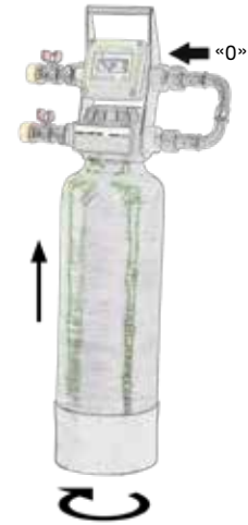
3. Skru på tanken, resett målecomputeren. Se bruksveiledningen.
