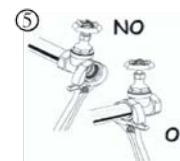
5 Ved montering, bruk skiftenøkkel, ikke rørtang, og bruk kun nødvendig vridningsmoment og kun på rørenden av sluseventilen. Dette gir et fastere grep og unngår potensiell skade på sluseventilens hus.
