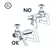
6 For å forhindre forvringning og skade på bevegelige deler, sett ikke sluseventiler i skrustikke på arbeidsbenk. Sett heller røret i skrustikke og skru sluseventilen på plass.
