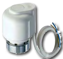
Elektrisk aktuator 24V Normalt åpen Åpne-/lukketid 180 sek.
