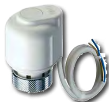
Elektrisk aktuator 230V Normalt åpen Åpne-/lukketid 180 sek.
